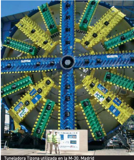
Tuneladora Tizona utilizada en la M-30, Madrid
