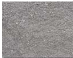
Sand Matrix® 0-2 mm , della linea Matrix, materia prima seconda di Officina dell' Ambiente, derivante dal trattamento delle scorie da incenerimento. Risulta particolarmente efficace come smagrante e limita il ricorso alle sabbie naturali nella produzione dei laterizi
