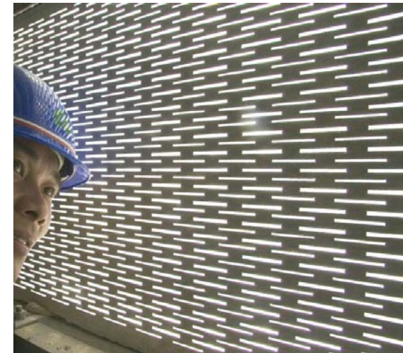
prodotto composito i.light , costituito da un nuovo tipo di materiale cementizio che, legando particolari resine, consente di fabbricare pannelli che trasmettono la luce (Italcementi, IT)
