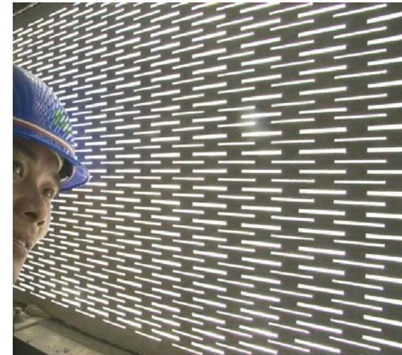
prodotto composito **i.light**, costituito da un nuovo tipo di materiale cementizio che, legando particolari resine, consente di fabbricare pannelli che trasmettono la luce (Italcementi, IT)
